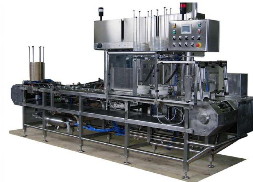
Questa macchina è idonea al confezionamento di torte ed è costituita essenzialmente da una stazione di prelievo del vassoio, una stazione di arrivo torta da nastro laterale, una stazione di montaggio cupola ed una stazione di pressatura cupola.
