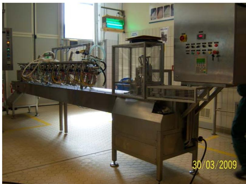
Questa macchina a movimento in continuo è idonea al dosaggio su vassoietti di prodotti semiliquidi ed è costituita essenzialmente da una stazione di prelievo del vassoio, una serie di dosatori che depositano a strati il prodotto ed una stazione di taglio ed espulsione. Il movimento della catenaria è effettuato da motoriduttore.
