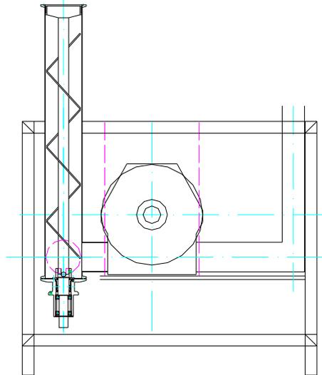
Questa attrezzatura è idonea nel miscelare prodotto liquido proveniente da freezer, miscelato con inclusioni secchi o umidi provenienti dalla tramoggia a nastro o coclea, una pompa a settori spinge il prodotto alla macchina di dosaggio, con agitatori interno. Completamente gestita con PLC di comando
