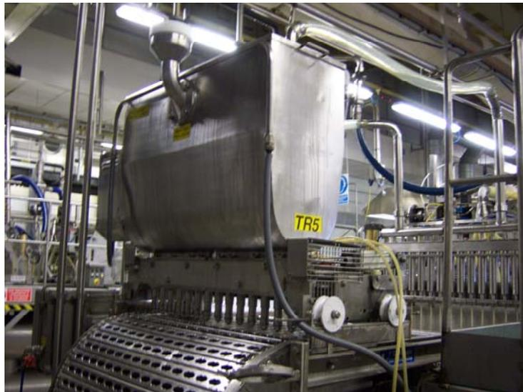
Questa attrezzatura è idonea nel miscelare prodotto liquido proveniente da freezer, miscelato con inclusioni secchi provenienti dalla tramoggia a coclea distribuendo in 14 uscite il prodotto sulla macchina di dosaggio, con agitatori interno.
