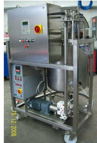
Questa attrezzatura è idonea nel miscelare prodotto liquido conservandolo a temperatura costante, con agitatore interno e pompa a membrana o positiva
