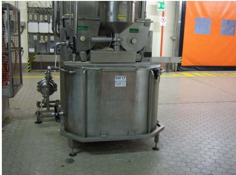
Questa attrezzatura è idonea nel miscelare prodotto liquido conservandolo a temperatura costante, con agitatori interno e pompa a membrana.
