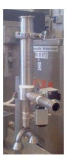
Questa attrezzatura è idonea al dosaggio volumetrico di prodotti semiliquidi zuccherosi, con adduzione principale, dei pistoni pneumatici superiori riempiono la camera di pompaggio e rubinetti a sfera 3 posizioni svuotano la camera, completamente registrabile nella sua posizione si adatta con qualsiasi ancoraggio a tutte le macchine. Ha una velocità di produzione collaudata di 60 colpi/1'
