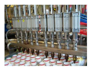
Questa attrezzatura è idonea al dosaggio volumetrico di prodotti liquidi, con adduzione principale, dei pistoni pneumatici superiori riempiono la camera di pompaggio e altri pistoni fanno da on – off, completamente registrabile nella sua posizione si adatta con qualsiasi ancoraggio a tutte le macchine.
