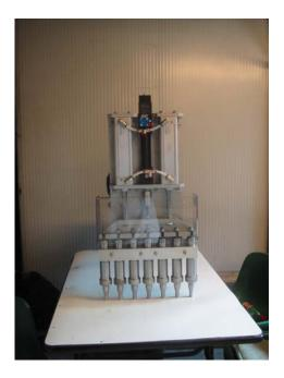
Questa attrezzatura è idonea al dosaggio volumetrico monogusto o decorazione di prodotti liquidi o semiliquidi, con valvole a singolo ingresso, apertura e chiusura della valvola comandata da pistoni pneumatici, completamente registrabile nella sua posizione si adatta con qualsiasi ancoraggio a tutte le macchine. Ha una velocità di produzione collaudata di 60 colpi/1'
