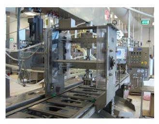
Questa attrezzatura è idonea ad ospitare i gruppi di dosaggio e dare un movimento di salita e discesa controllato mediante riduttore di precisione e motore Brushless. Massima precisione nel controllo del movimento verticale. Ha una velocità di produzione collaudata di 60 colpi/1'
