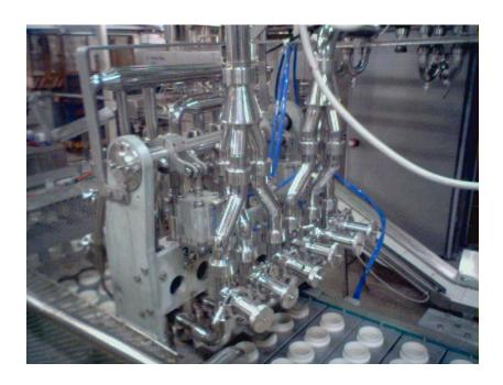
Questa attrezzatura è idonea al dosaggio di prodotti liquidi e cremosi, con valvole a singolo e doppio ingrasso, apertura e chiusura della valvola comandata da pistoni pneumatici, completamente registrabile nella sua posizione si adatta con qualsiasi ancoraggio a tutte le macchine.
